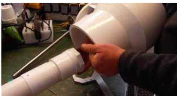
ベーンフランジを回転させながら、大きなナットを写真の様に保持して、ベーンフランジを元の位置にはめ込みます。きつくきつく締め込みます。
