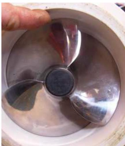
(左写真)底からプロペラを見てセンター外れていると側面が擦れますのでドライブシャフト管（大き目の管）を下の写真の様に叩いてセンターを出します。
