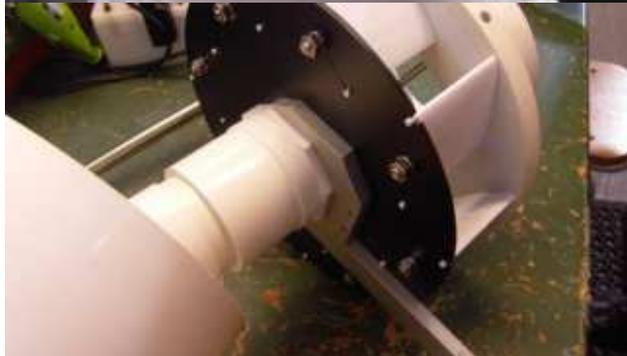
駆動軸とプロペラを引き出します。カップリングから取るには力を入れ回転します。
