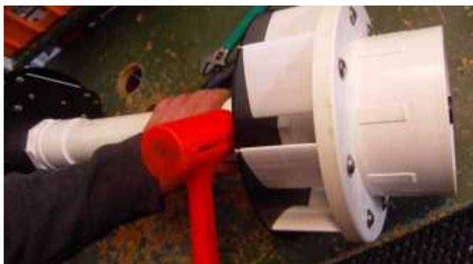
プロペラがPVCハウジングの中央に来るまで工夫します。プロペラが容易に回るまで繰り返します。使用すると固くなり、中央部に固定され、丁度良い所に収まります。
