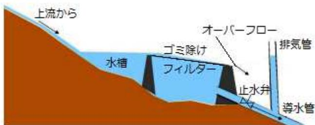
流量10ℓ/秒の流れに対し取水槽にオーバーフロー機能を持たせ、0.5m<sup>2</sup>の面積に1-3mmのメッシュをかませ、ゴミ類がオーバーフロー水と共に流れ出て貯水槽内にゴミが入らない構造をお勧めします。(詳しくは取水技術書をお読みください)
