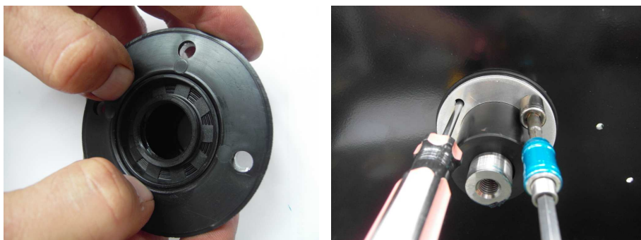
シールをトップカップに取り付けそれからヘッドを取付けます。スクレュードライバーを穴に通して位置を確認します。固定は5Nmの力です。
