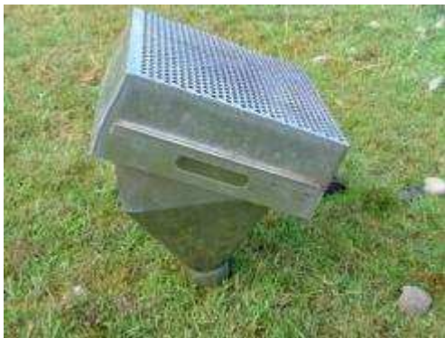
ステンレス応用取水口の例
