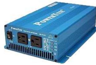
する場合に変換ロスを考える必要はありません。インバーターには交流正弦波を出力するものと、方形波を出力するものがあります。少し価格は上がりますが交流正弦波出力を使用されることをお勧めします。この価格帯のインバーターは通常は過負荷は 130% 程度を 3 分間、瞬時過負荷は 300% 程度は耐えられるようになっています。また低電圧保護回路があり、おおむね DC12V 入力の場合、電圧が 11.5V に低下すれば低電圧保護が働きインバーターは停止します。機器の仕様を良く確認し購入してください。
