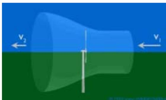
ここで、風速の平均値を考えます。発電機に入り込む前の邪魔されない風速  $v_1$  と羽根を出た後の風速  $v_2$  の平均を出します：計算式は  $(v_1 + v_2)/2$ 。
