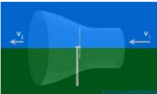
風力発電機の回転翼は風の運動エネルギーを補足した時点で機械運動エネルギーに変換する訳ですから、風速は低下します。この事により風速は右に入り込む速度より羽根から左に離れる方が遅くなる筈です。毎秒ごとに羽根の円面積に入り込む風の量は回転翼の左側で離れさる量と同等の筈です。従って回転面背後の直径(断面)
