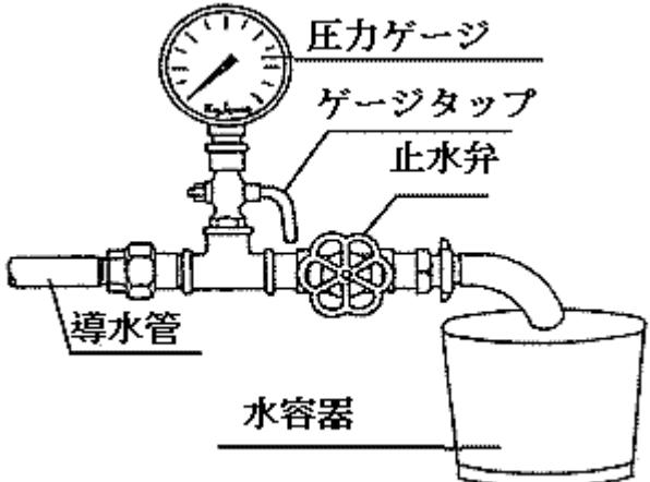
最適な発電環境を見出す為に、出来るだけ精密な圧力計をご使用下さい。ゲージ表示範囲は目的とする高さより、やや大目のスケールが適しています。例えば 50m とご存知の場合、ゲージ目盛りは最低で 6kg/cm<sup>2</sup> 最大 10kg/cm<sup>2</sup> が適しています。止水弁の直径も導水管の太さと合致した物を使用することも大切です。水容器もその容量を知っておく必要があります。目的とする期待量の最低 20 秒間を受け入れられる量が必要です。小さめの容器では正確な測定は出来ません。
