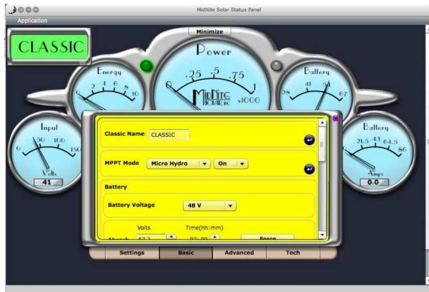
MPPTの動きの詳細設定は TECH メニューで設定が必要です。Techを押し、Twiddle Dither欄を探します。
