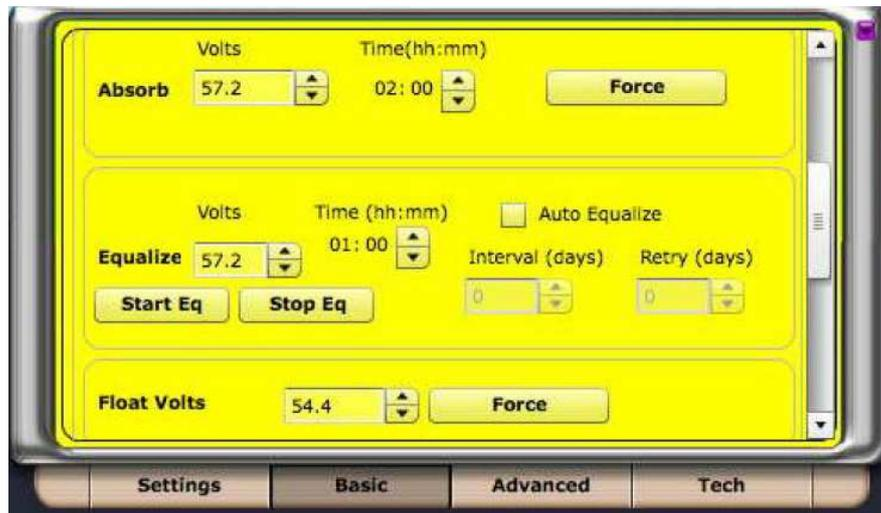
電圧関係の全てのパラメーターをこの画面で指定する事が出来ます。充電工程で強制的にいずれかの段階（アブソープ、フロート、均一化）に移行させることも可能です。例えばフロートを強制するにはセット値を指示し、Forceボタンをエンターします。
