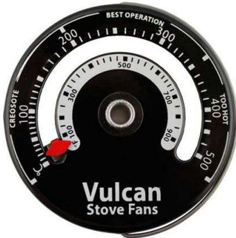
この温度計で、ストーブ温度が 150~350℃以内か観察する事が出来ます。温度が低い場合、クレゾール成分が貯まり、内部や煙突がドロドロ成分で覆われます。反対に温度が高すぎると、ストーブの寿命が短くなり同時に温度効率が低下しています。磁石によりストーブ金属部に固定できます。
