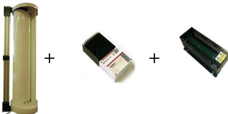
特長は、太陽光パネル用充電制御器電圧以上の設定電圧で蓄電池の満充電を防止出来ます。羽根回転停止スイッチ（内部回路短絡モード用）は使用されても問題ないですが、通常不必要とお考えください。通常環境使用では LV-v150 型で十分ですが、瞬間風速が 27m/s 以上の山頂場所や、気温がマイナス 40℃に到達する極寒地では LV-v150Extreme をご使用下さい。**Extreme** は極悪環境から派生する金属疲労対策を施し、ベアリングも冷寒地に耐える物を使い、又全体色を黒色にして遠赤線を吸収し易くし、本体温度を少しでも上昇させる工夫が施されています。又一番上部の本体保護カバー材質はポリカーボネート樹脂を採用しています。発電機の性能も向上させています。ご注文時 12,24, 48V 蓄電池電圧のご指定が必要です。
